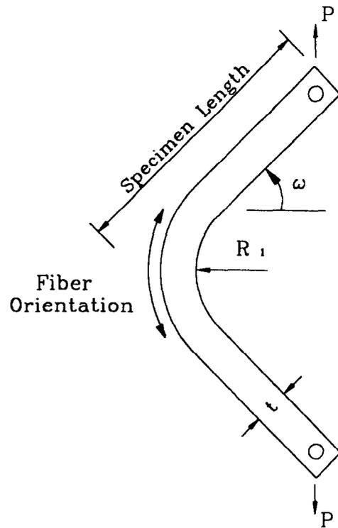
Figure 6 L-beam specimen<sup>15</sup>
