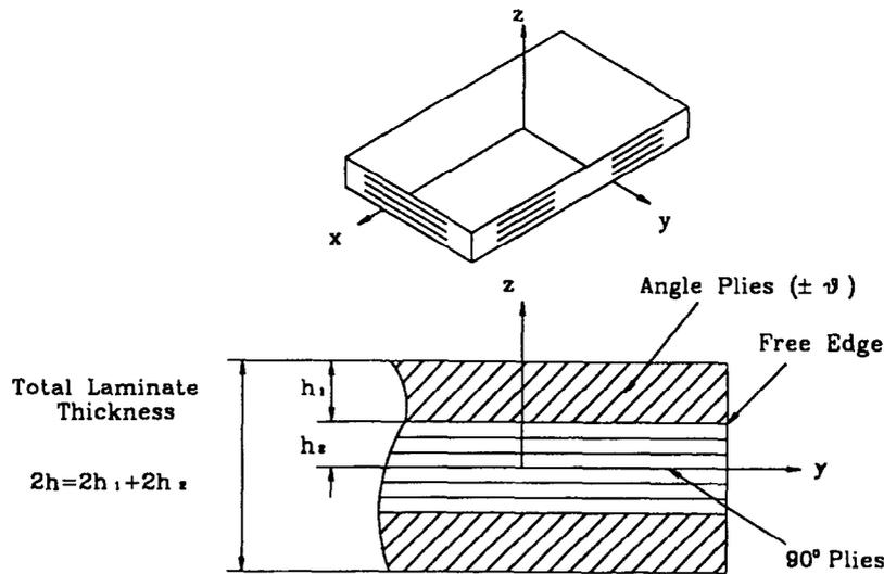
Figure 1 Delamination coupon<sup>6</sup>
